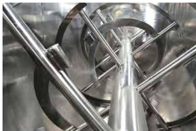
El eje está sellado con un prensaestopas con múltiples empaquetaduras de PTFE (a veces con un anillo linterna para purga de aire) en ambos extremos. Los materiales se cargan desde la parte superior y una válvula de descarga de ajuste al ras está ubicada en el centro de la parte inferior. La altura de descarga se puede ajustar según los requisitos, de modo que el material se descargue en el contenedor debajo sin polvo flotante.
