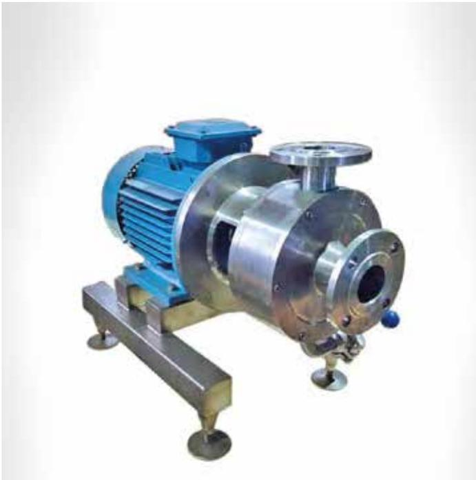
Un mezclador en línea es un mezclador de alto cizallamiento para operación en línea o continua. En el proceso Inline, el mezclador se instala fuera del tanque. Esto facilita su integración en una línea de producción existente con conexiones normales de entrada/salida.
