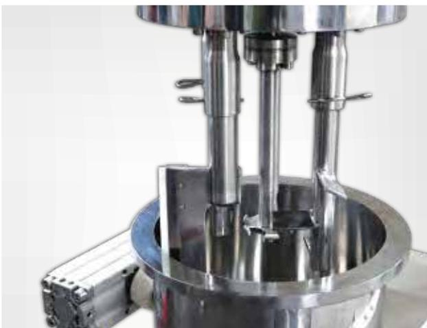
La mezcladora planetaria doble de la serie PDP de PerMix también se denomina amasadora planetaria doble porque se puede utilizar para manejar materiales muy viscosos de hasta 1.500.000 cps. Por lo general, el mezclador planetario doble de la serie PerMix PDP tiene dos herramientas de mezcla montadas verticalmente que son impulsadas por un engranaje para moverse alrededor del eje central del tanque, así como su propio eje.
