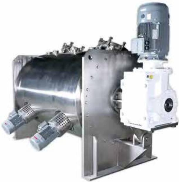
El secador mezclador al vacío de la serie PerMix PTP-D es un reactor-secador de mezcla turbulenta. Se utiliza como mezclador secador de alta velocidad, reactor químico o, si se combinan ambos procesos, como secador-reactor. Se utilizan con especial éxito en reacciones heterogéneas de secado rápido sin aglomeraciones con sistemas de diferentes sustancias, extracción, esterilización y, en general, para ayudas de vacío, presión positiva, energía térmica y trituración.
