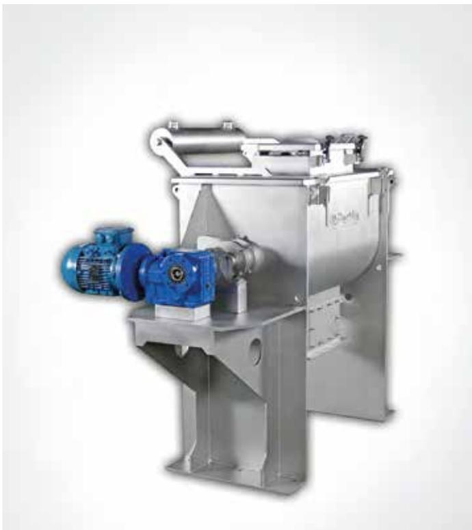
El mezclador de cinta helicoidales de la serie PerMix PRB es una máquina mezcladora eficiente y versátil para mezclar polvos secos, gránulos y pastas viscosas de manera homogénea. Es capaz de dar un "grado de homogeneidad" satisfactorio para trabajos de mezcla debido al diseño especial de un agitador de mezcla con cintas dobles dentro de un canal de trabajo en forma de U.
