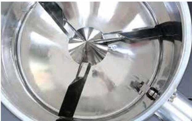
El mezclador de alta velocidad de la serie PerMix PDI, también llamado mezclador granulador, granulador húmedo o mezclador granulador de alto cizallamiento, es una máquina mezcladora eficiente y versátil para mezclar polvos secos o granular con la adición de aglutinante líquido, en muy poco tiempo y con excelentes habilidades de limpieza. Es capaz de dar un resultado perfecto para la mezcla debido al diseño innovador de un mezclador tipo impulsor central con un picador vertical lateral.
