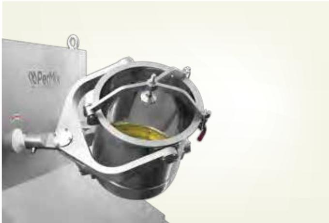
Para el tamaño de máquina de PTU-5, PTU-15 y PTU-50, PerMix ofrece la opción de que el mezclador 3D funcione con tambores intercambiables. El soporte de tambor está diseñado para sujetarlo con un montaje rápido. Cuando la mezcladora gira, los dos brazos giran juntos el tambor y el soporte del tambor.
