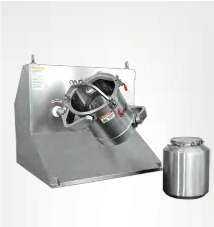
El mezclador 3D de la serie PerMix PTU o el mezclador de polvo multidireccional se utiliza para la mezcla homogénea de sustancias en polvo con diferentes pesos específicos y tamaños de partículas. También es posible producir mezclas de seco a húmedo y de húmedo a húmedo. El proceso de producción es higiénico y libre de polvo porque el producto se mezcla en contenedores independientes de tamaños variables.
