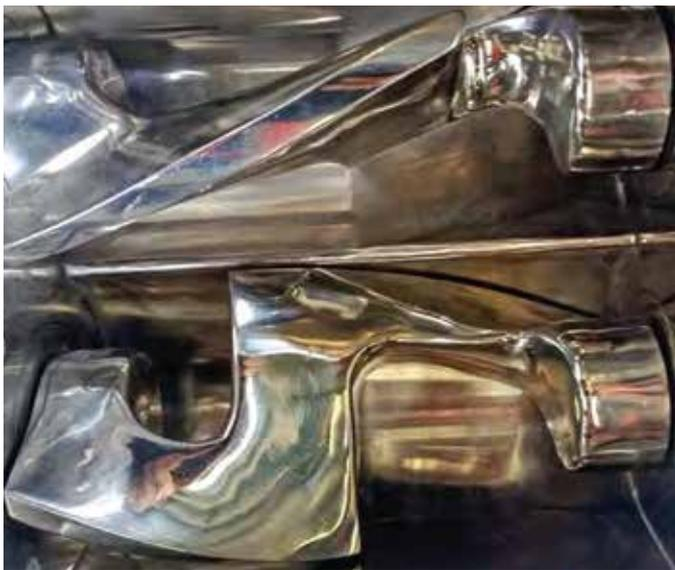
La acción de mezcla es una combinación de movimiento a granel, estiramiento, plegado, división y recombinación a medida que el material se tira y se aprieta contra las hojas, la silla de montar y las paredes laterales. Continuamente, nuevas capas de material se comprimen y se pliegan unas sobre otras y se someten a fuerzas de cizallamiento. Se forman nuevas superficies y los componentes pueden penetrar.
