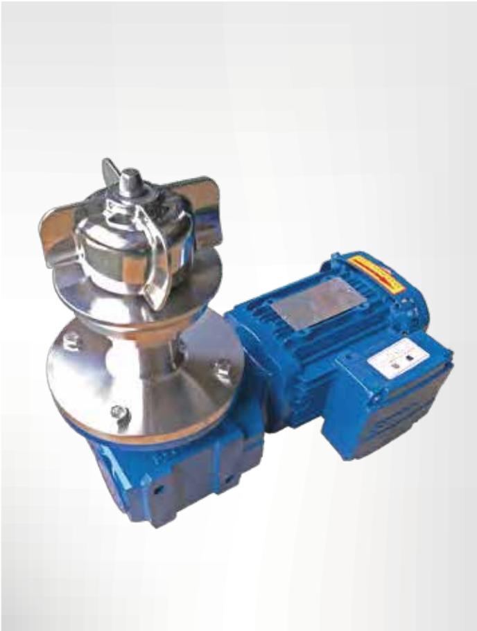
La gama de mezcladores magnéticos de la serie PerMix PM utiliza una tecnología especial de conducción magnética y sin sellado, que es totalmente diferente de los agitadores comunes de transmisión por engranajes.
