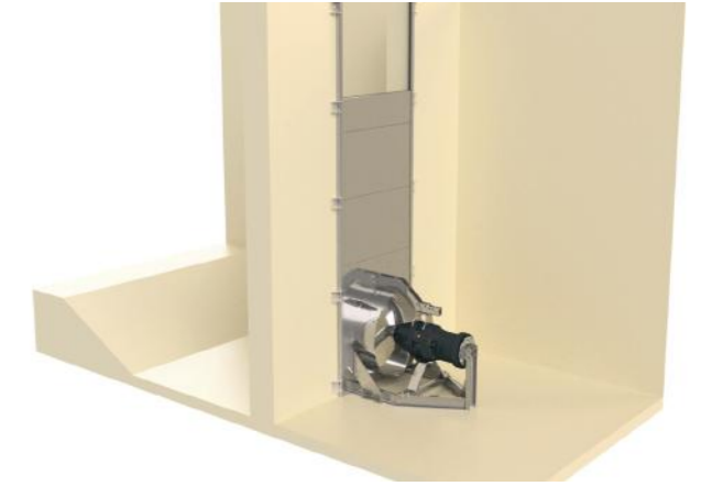
Bastidor de circulación con rieles en Z Circulation Frame with Z Rails
