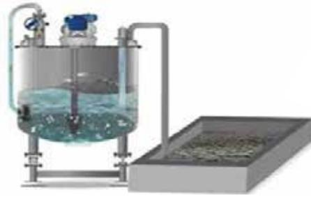
Después de la primera medición, el sistema de automatización toma automáticamente la cantidad de agua dulce añadida para diluir la mezcla o la cantidad de agua gris añadida para aumentar la densidad en el tanque y prepara la mezcla.
