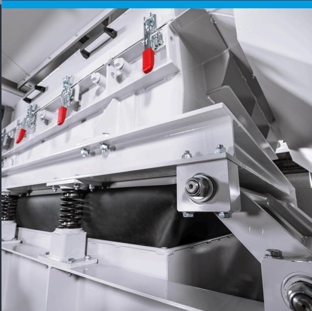
Las mesas de densidad seca GSort R y GSort M ofrecen un método sin agua para la separación de materiales, combinando precisión mecánica con un menor consumo energético. Su diseño permite un manejo uniforme de diversas materias primas, al tiempo que reduce el impacto medioambiental en el funcionamiento diario.
